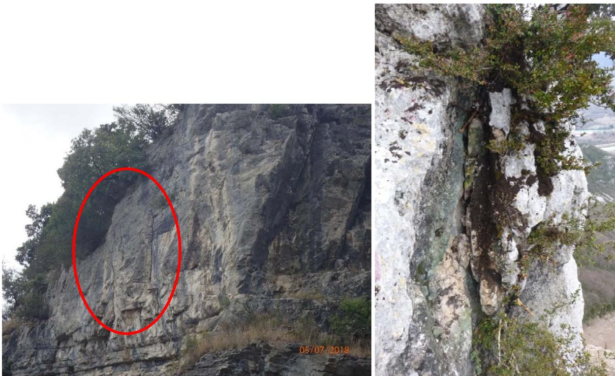
*illustration 47 – exemples de rupture plan possible (écaille) et panneau (CAN)*
